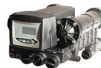
Блоки управления позволяют промывать загрузки скорых фильтров обратным потоком воды (снизу вверх), прямым потоком воды (сверху вниз), производить промывку реагентом путем всасывания его через встроенный эжектор, автоматически наполнять реагентный бак водой. Блоки состоят из клапанов, которые осуществляют включение, выключение и перенаправление потока воды, и контроллера, обеспечивающего работу клапанов, то есть задающего последовательность переключения потоков.
