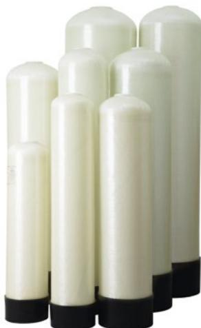
Корпуса скорых фильтров Sanature выполнены из композитного материала, на который намотана стекловолоконная нить по бесшовной технологии. Все резьбовые отверстия в корпусах сделаны из стеклонеполненного полипропилена для обеспечения высокой прочности; резьбовая вставка снабжена механическим замком. Толщина стенки корпуса варьируется в пределах от 3,0 до 8,0 мм в зависимости от его диаметра. Все части корпусов, контактирующие с водой, выполнены из коррозионностойких материалов пищевого качества.
