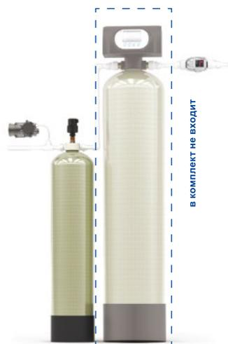
Блок аэрации предназначен для насыщения обрабатываемой воды кислородом, с целью окисления содержащегося в ней растворенного железа. Может быть использован перед фильтрами с каталитическими загрузками (Birm, Pyrolox и т. п.).
