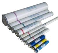
Мембраны серии ULP изготовлены из ароматического полиамида, их основными достоинствами являются: очень низкое рабочее давление, высокая производительность, прекрасное обессоливание при решении задач опреснения поверхностной воды и воды из подземных источников (с общим солесодержанием до 2 г/л).
