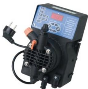
Насосы DLX – соленоидные цифровые дозирующие насосы пропорционального действия с микропроцессорным управлением. Насосы выполнены в антикислотном исполнении, панель управления защищена от УФ-излучения пленкой. Стандартная высота забора реагента – 2 метра.
