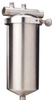
Корпус фильтра состоит из основания и крышки, соединенных между собой хомутом. Фильтрующий мешок вставляется в каркас жесткости. Сверху она закрывается крышкой каркаса и зажимается держателем. В комплект фильтра входит кронштейн для размещения его на стене.
